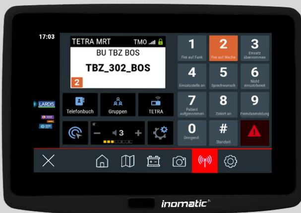
Durch die direkte Integration des LARDIS-Systems in die inomatic Mangora®- APP (optional) kann, neben der einfachen Bedienung von einzelnen oder mehreren TETRA- und Analog-Funkgeräten, im Einsatzfall ein automatisches Routing des Navigationssystems durch die Übertragung der Einsatzdaten per TETRA-SDS durch die Leitstelle erfolgen. Ebenso können Kurznachrichten und Statusmeldungen von der Einsatzleitstelle vom Mangora® über LARDIS-ONE und LARDIS-PILOT gesendet und empfangen werden.
